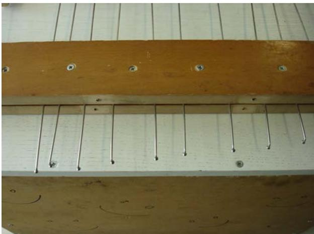
herausragen. Mit Flügelschrauben ist es beim Stimmen am einfachsten die Speichen zu lösen und wieder fest zu schrauben. Das Ganze auf einen Holzkasten oder Schrank als Resonanzkörper nageln. Man zupft an den Speichen, sodass sie schwingen und Töne erzeugen.
